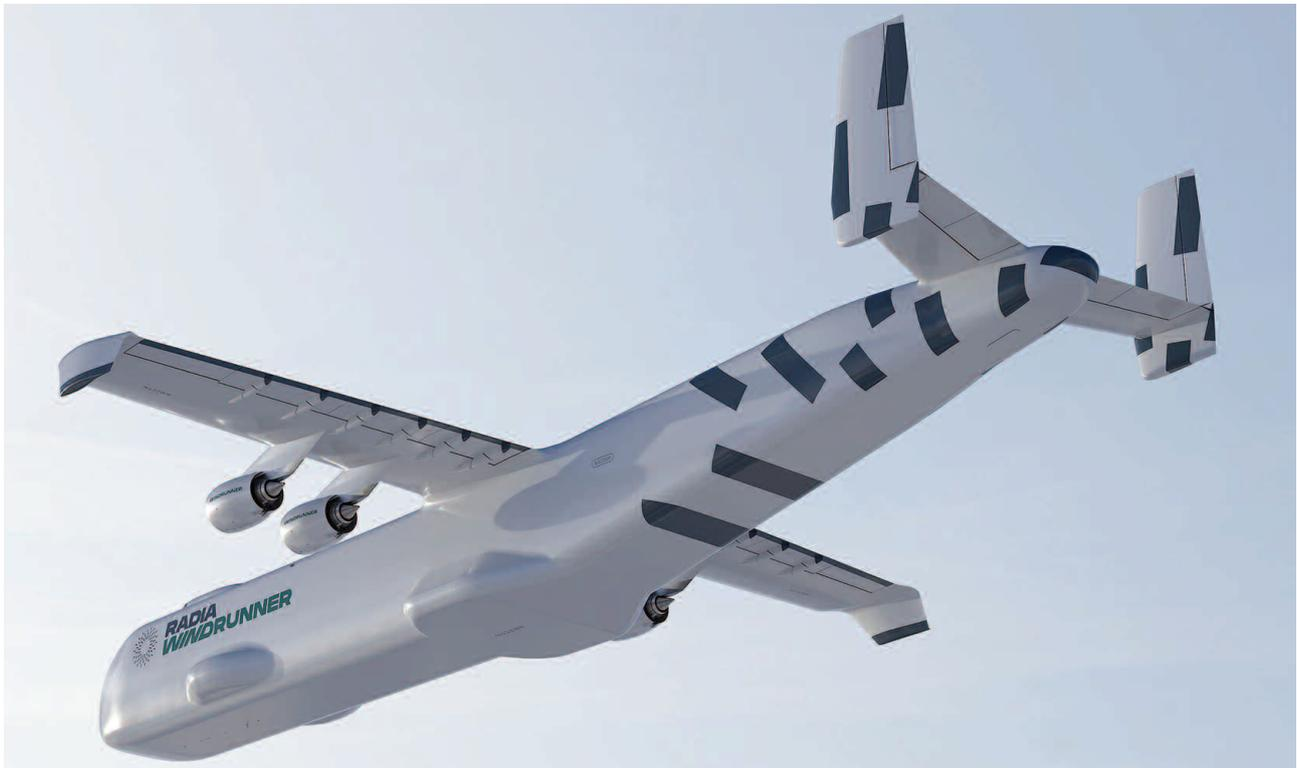
Radia, una empresa de energía de Colorado, centrada en ampliar radicalmente el alcance y la escala de la energía eólica terrestre, está desarrollando el avión más grande del mundo por longitud y volumen de carga, el WindRunner, diseñado específicamente para entregar las palas y componentes de
