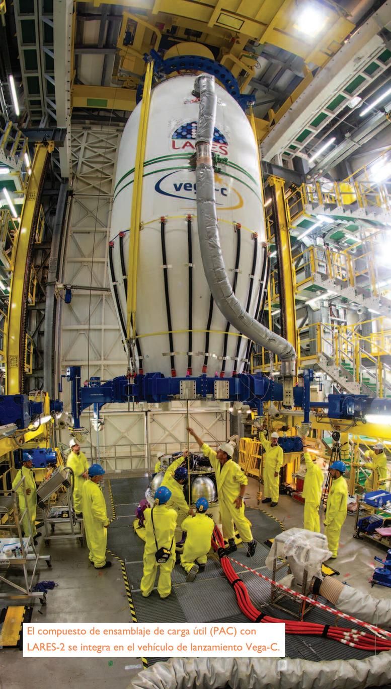
El compuesto de ensamblaje de carga útil (PAC) con LARES-2 se integra en el vehículo de lanzamiento Vega-C.
